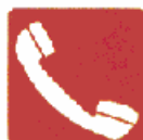
Teléfono para la lucha contra incendios.
