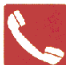
Teléfono para la lucha contra incendios.
